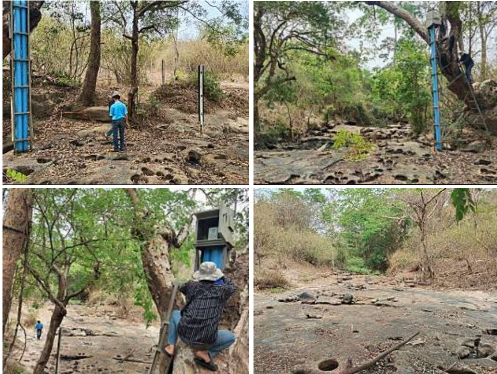
รูปที่ 5.2.2-16 การสำรวจรูปตัดขวางลำน้ำและสำรวจปริมาณน้ำ สถานี Kh.118 บ้านแก่งแต้ ตำบลบ้านค้อ อำเภอดำชะอี จังหวัดมุกดาหาร
